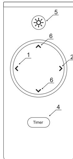
Timerfunktion: Du kan indstille emhætten til at slukke automatisk indenfor et tidsrum på 10 og 90 minutter (indstilles i intervaller à 10 minutter).
