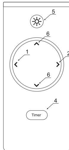
**Timerfunksjon:** Du kan stille inn ventilatoren til å slå seg av automatisk innenfor et tidsrom på 10 og 90 minutter (stilles inn i intervaller à 10 minutter).
