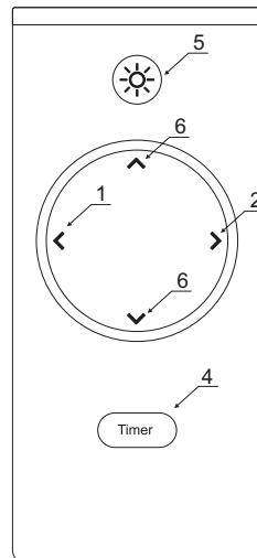
**Timerfunktion:** Du kan ställa in fläkten så att den stängs av automatiskt inom ett tidsrum på 10 och 90 minuter (ställs in i intervaller å 10 minuter).
